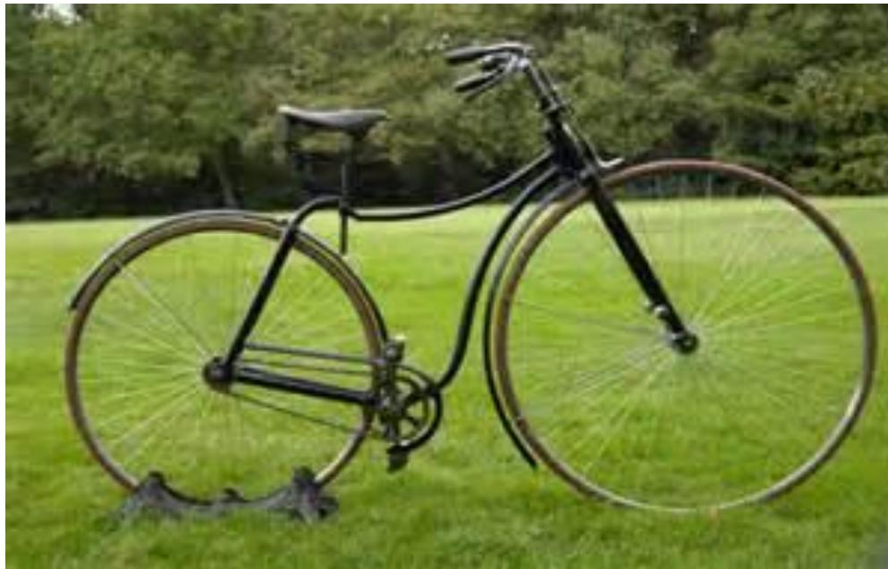
La safety bicycle (“bicicletta di sicurezza”), chiamata anche “Rover”, nacque nel 1884. Aveva ruote della stessa dimensione e trasmissione a catena. In seguito l’applicazione dei pneumatici ne aumentò il comfort. Le successive modifiche si riferirono solo all’uso di materiali più idonei e ad alcuni miglioramenti tecnologici, ma grosso modo questo modello è quello che è arrivato fino ai giorni nostri.
