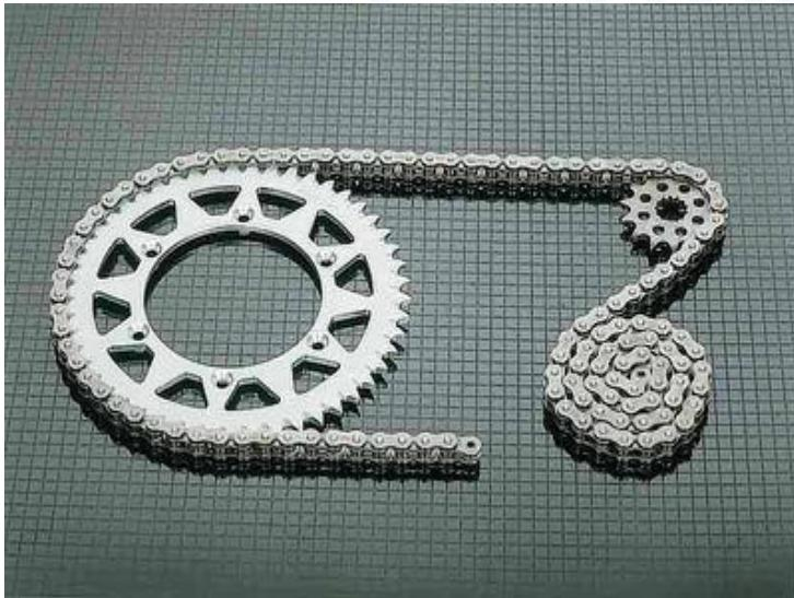
E' l'insieme degli ingranaggi e meccanismi che consente la trasmissione del movimento dal conducente alla ruota posteriore. Sono:
